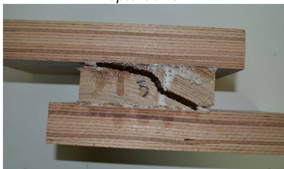
Rupture selon zone initiale poreuse
