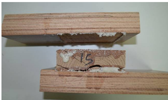
Rupture dans le joint de collage
