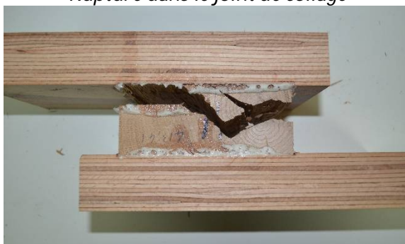
Rupture en coin
