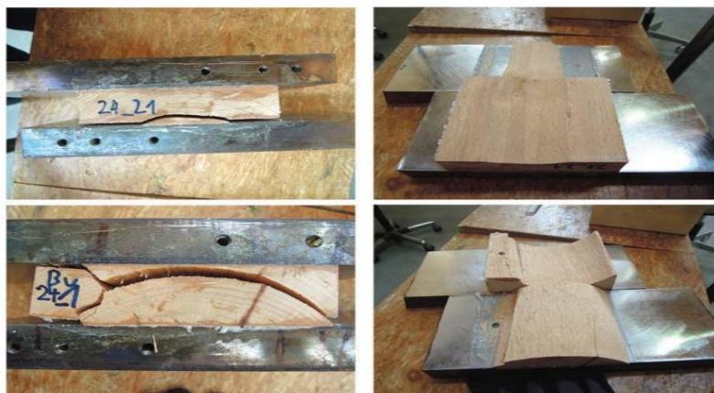
Figure 1-3 Rupture selon les cernes en cisaillement roulant dans du hêtre – Figure 3-17 de EHRHART [10].
