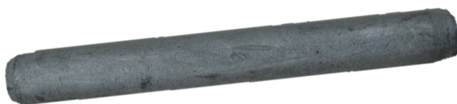
Figure 1-3 Aspect des broches utilisées pour les essais d'enfoncement.
