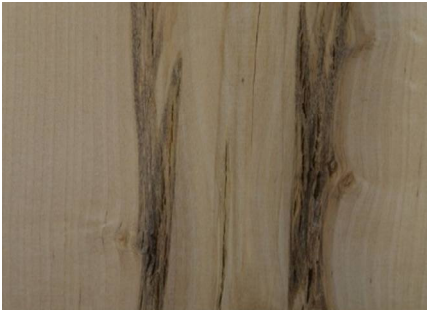
Coeur rouge fissuré
