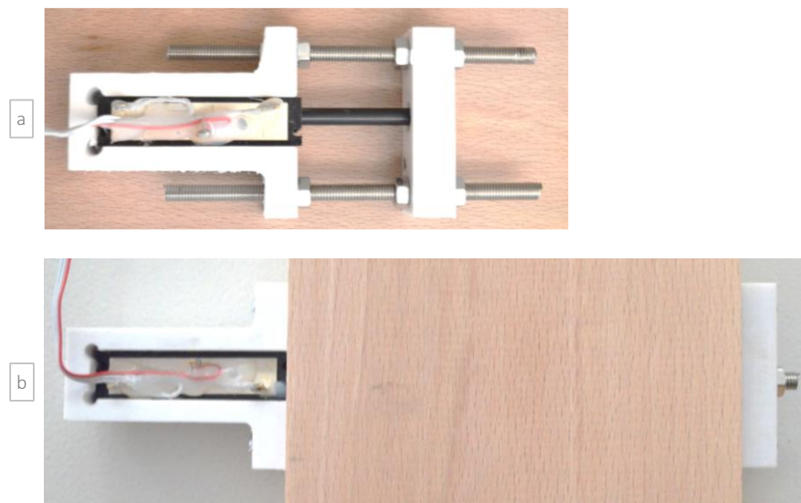
Figure 3-5 Photo d'un capteur de « suivi » dans un support (a) et photo du système de mesure des déplacements sur une éprouvette (b)
