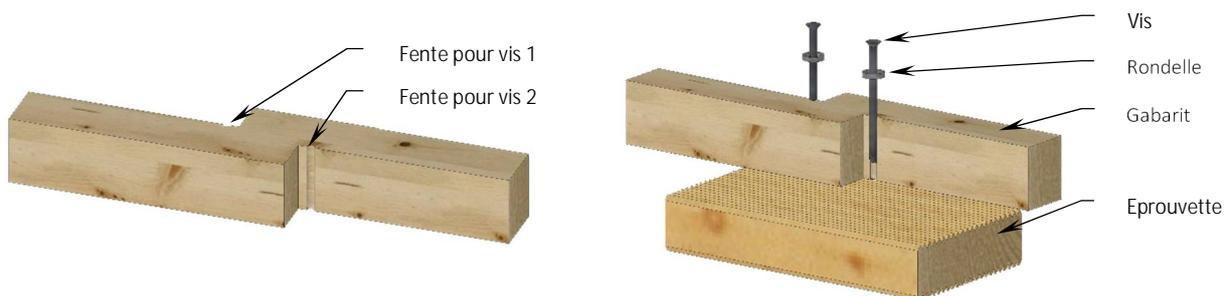
Figure 4-3 : Gabarit de mise en place de deux vis
