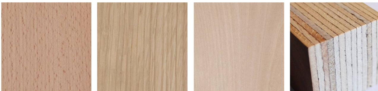
Figure 2-3 : Vue macroscopique (de gauche à droite) du hêtre, du chêne, du bouleau, du LVL à plis croisés
