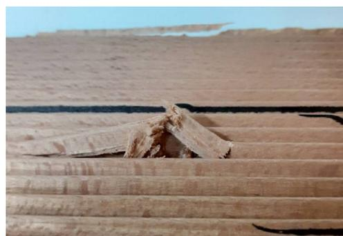
Figure 6-9 C1 – Mode de rupture observé sur le hêtre
