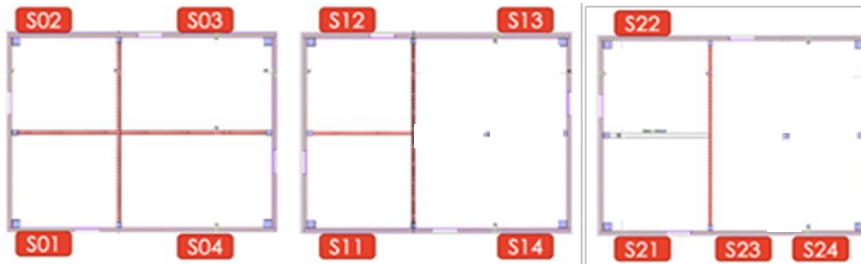
Figure 3.1.8 : Isolement au bruit aérien en transmission verticale entre grands volumes avec un poteau assemblé en ferrure en âme.
