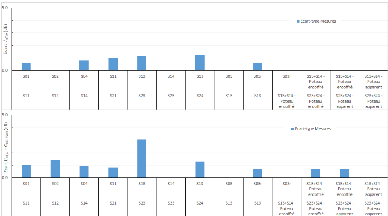
Figure 8.2.4 : Ecart-type de mesure et écart entre mesure et prévision pour le niveau de bruit de choc – Direction verticale.
