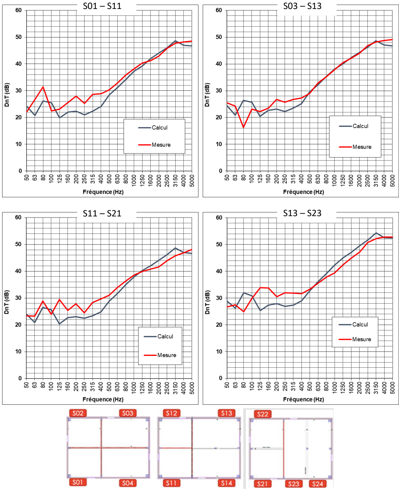
Figure 2.1.1 : Isolement au bruit aérien en transmission verticale.
