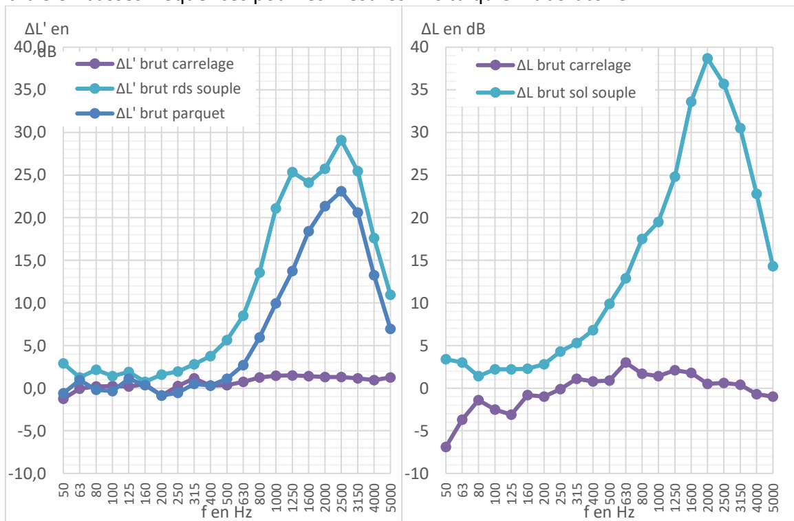
Figure 3.5.3 : Spectres d'amélioration des revêtements de sol (à gauche in-situ et à droite en laboratoire).
