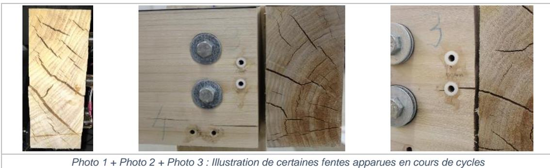
Photo 1 + Photo 2 + Photo 3 : Illustration de certaines fentes apparues en cours de cycles
