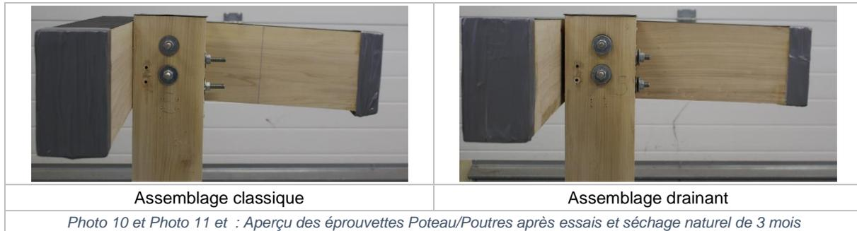
Ces deux premières photos permettent de voir que les lignes directrices des poutres et du poteau ne sont plus perpendiculaires, dans les deux cas. Il apparaît nettement malgré tout que l'assemblage qui s'est le plus relâché est l'assemblage classique. Nous pouvons notamment apercevoir la face supérieure de la poutre de gauche, non visible dans le cas de l'assemblage drainant.
