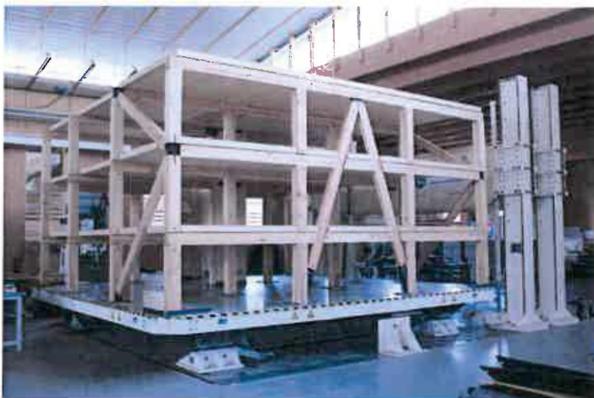
*Photo 5 : Maquette d'essai assemblée sur la table sismique*
