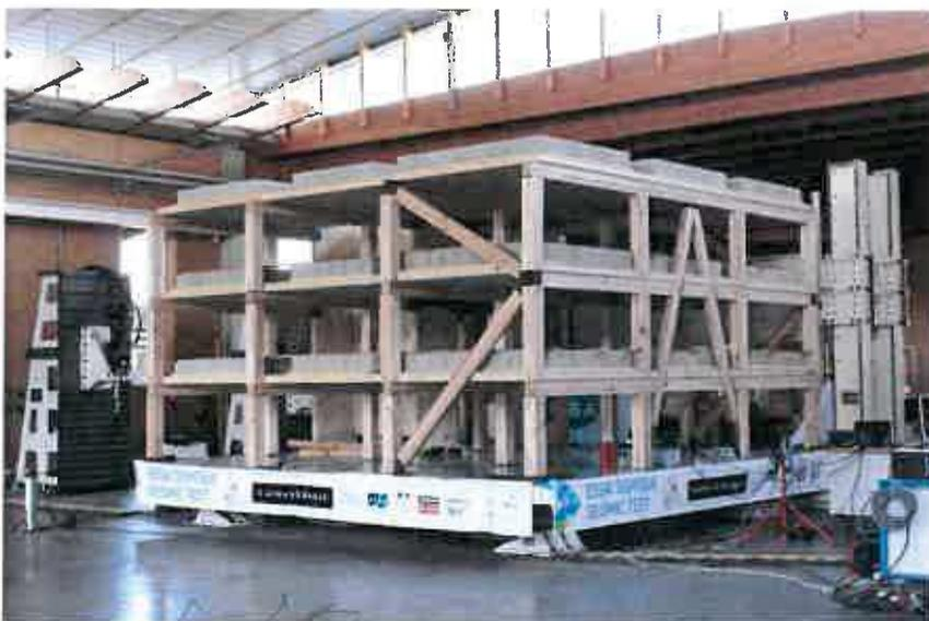
*Photo 6 : Maquette avec masse additionnelle par blocs de béton*
