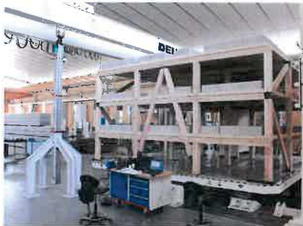
*Photo 4 : Potence support de capteurs à fil et station d'acquisition de données*
