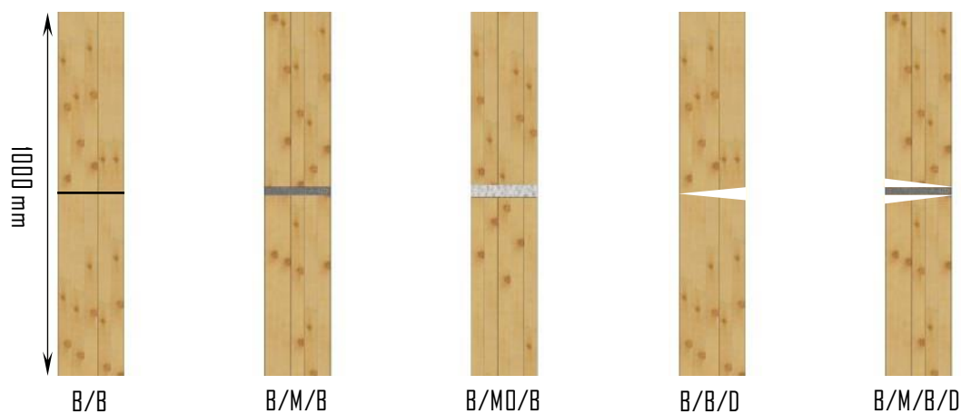
Figure 6-1 : Schéma des configurations d'assemblages par contact à tester.
