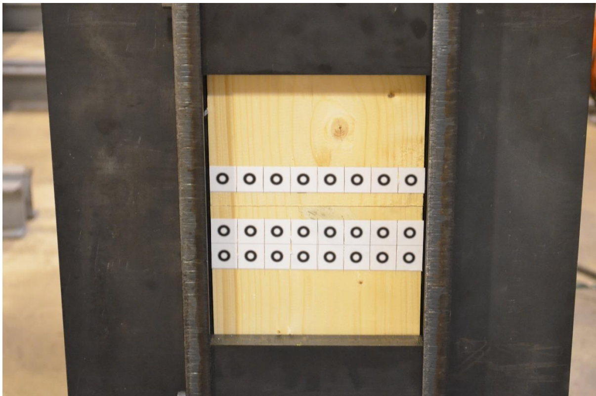
Figure 1-4 : Echantillon B-B en contact parfait dans l'enceinte.
