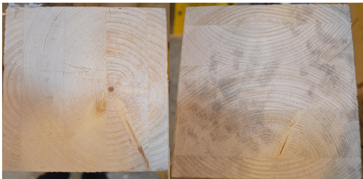
Figure I-23 : Rupture en compression de l'échantillon B-ME-D-5
