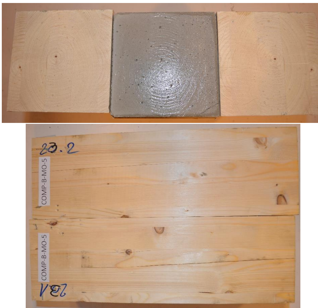
Figure 1-15 : Aucun matage de surface n'est observable, les ruptures apparaissent par flambement de lits de trachéides en différents endroits de l'échantillon B-MO-5
