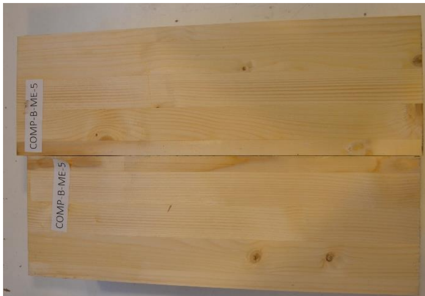
Figure I-II : Matage uniforme des surfaces de contact très peu perceptible et lignes de rupture par flambement de lits de trachéïdes en différents endroits de l'échantillon B-ME-5
