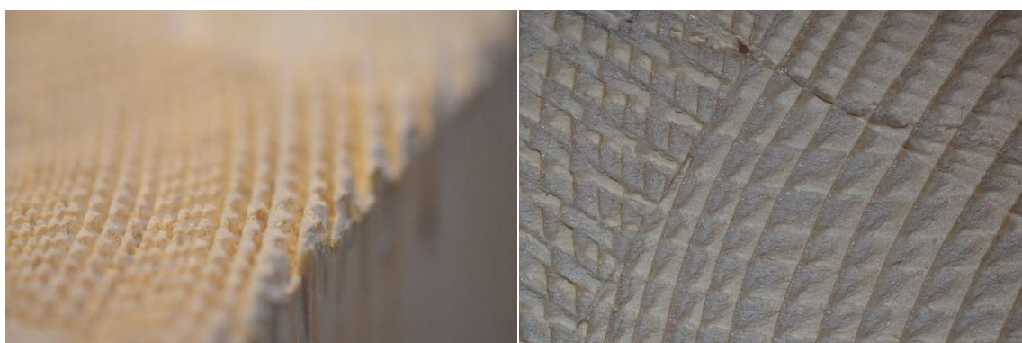
Figure I-20 : Exemple de matage en compression de l'interface des échantillons « B-B-D »
