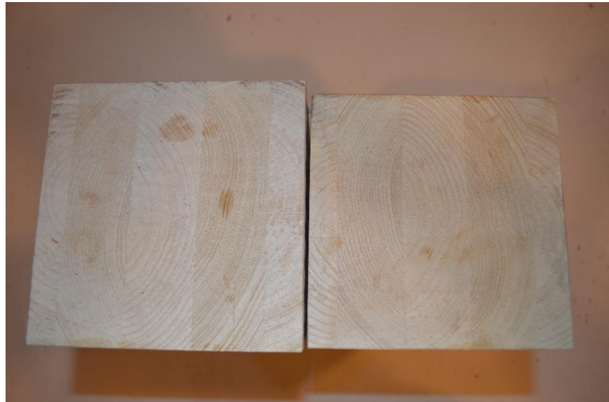
Figure 4-6 : Matage uniforme des surfaces de contact très peu perceptible sur l'échantillon B-ME-5 essai bois/métal.
