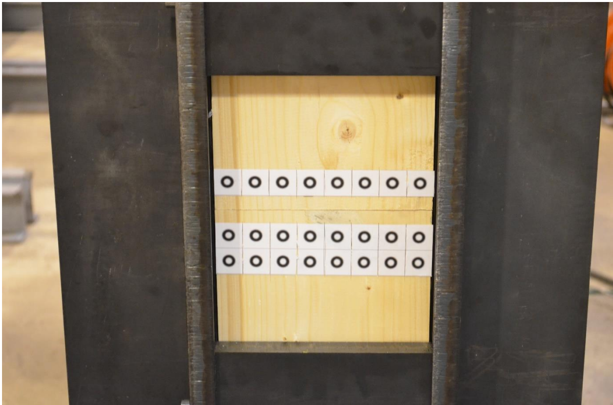
Figure 4-3 : Échantillon d'essai de contact bois/bois B-B en contact parfait dans l'enceinte de confinement métallique.
