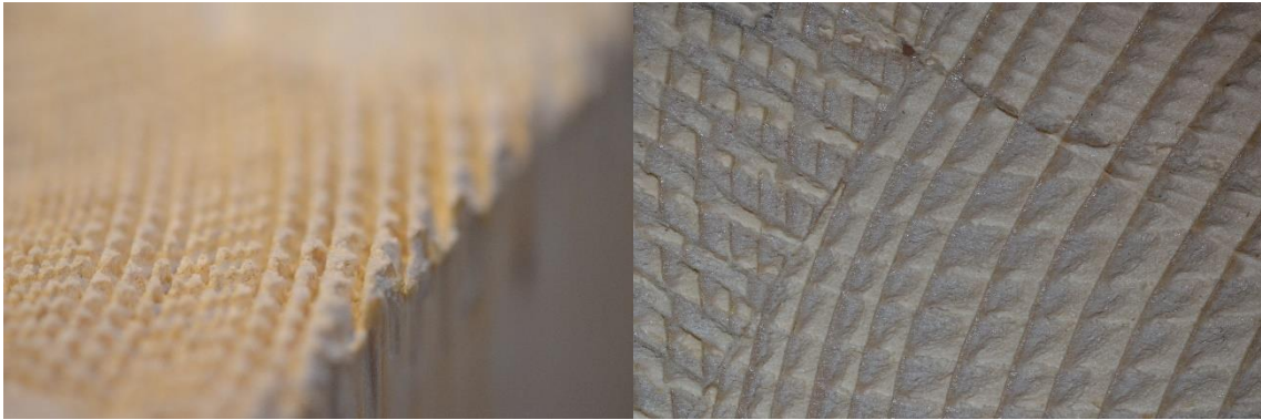
Figure 4-2 : Exemple de matage en compression de l'interface des échantillons bois/bois avec défaut géométrique « B-B-D »
