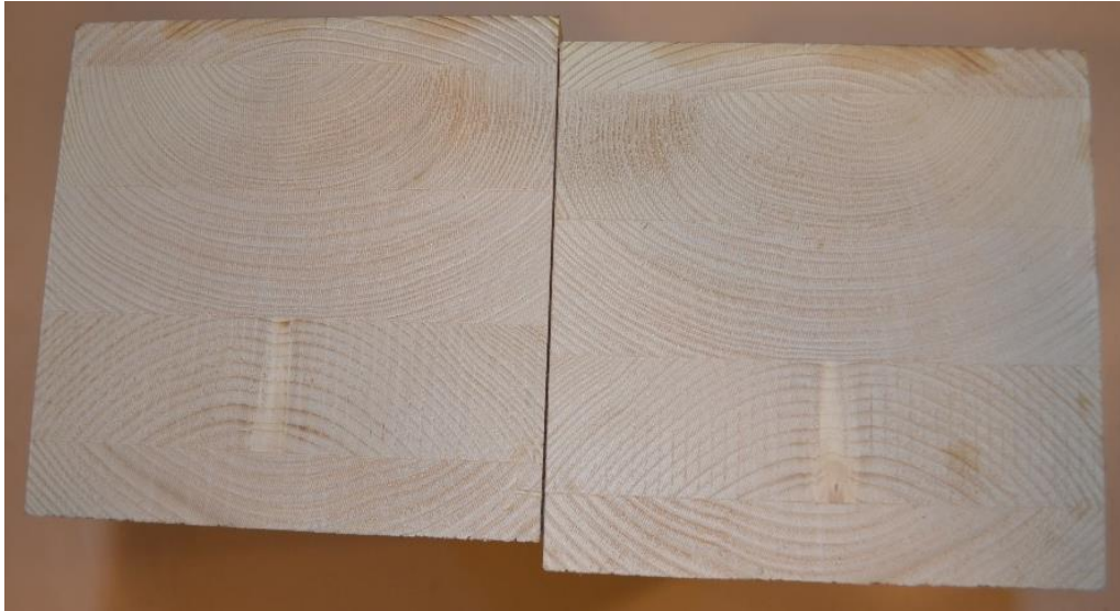
Figure 4-4 : Matage des surfaces de contact très peu perceptible après essai bois/bois sur l'éprouvette B-B-5.
