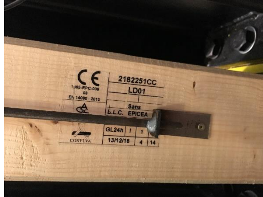
Figure 1. Caractéristiques de la poutre en Epicéa GL24h
