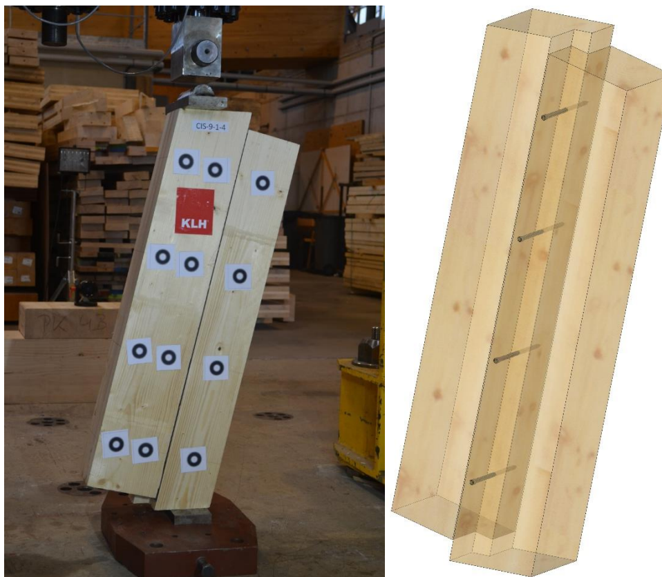
Figure 2-24 : Echantillon de la configuration CIS-9-1 (assemblage à mi-bois des panneaux et vissage à 90°)
