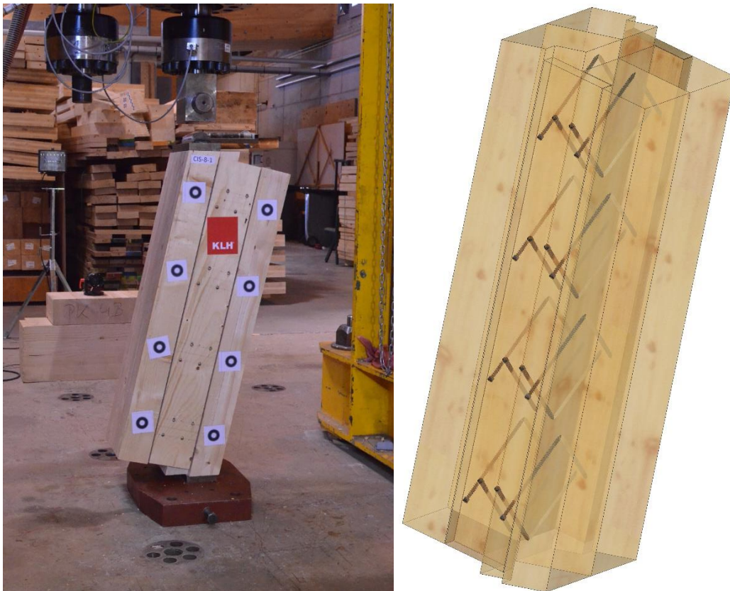
Figure 2-9 : Echantillon de la configuration CIS-6-2 (Rainure et languette LVL double vissage à 45^\circ )
