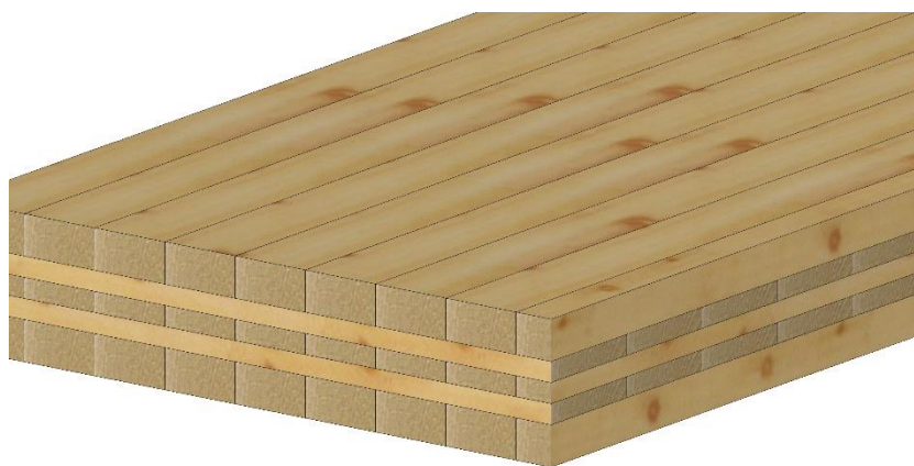
Figure 2-1 : Constitution d'un panneau CLT
