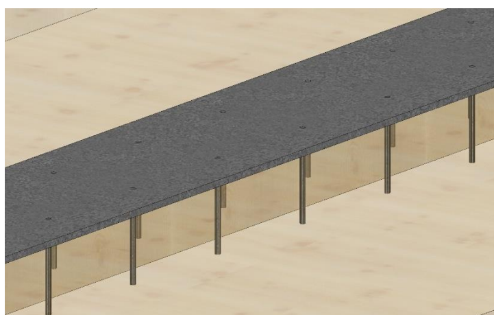
Figure 3-10 : Principe d'assemblage avec des vis et plaque métallique \varepsilon = 0^\circ et \theta = 0^\circ
