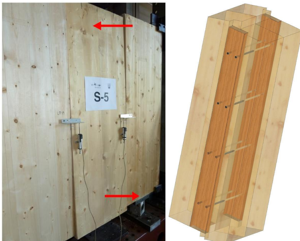
Figure 1-5 : Observation du moment parasite [8], proposition de configuration d'éprouvette
