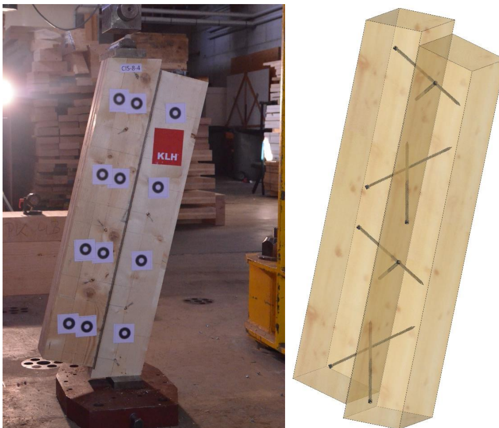
Figure 2-19 : Echantillon de la configuration CIS-8 (vis inclinée à 2 \times 45^\circ sur bord franc)
