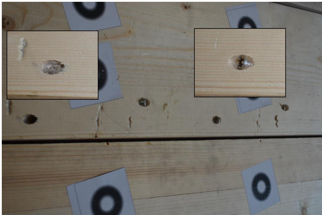
Figure 2-32 : Mode de rupture des assemblages de la configuration CIS-9-2
