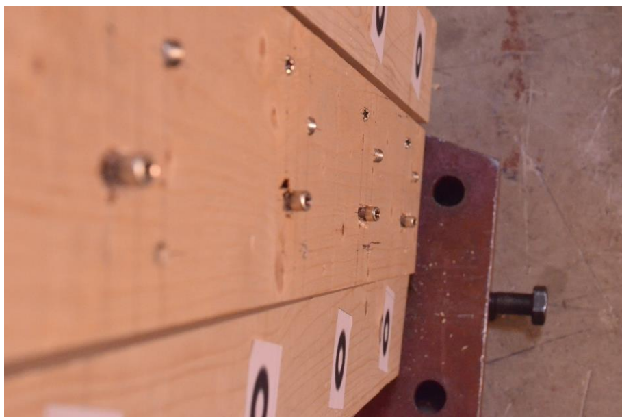
Figure 2-12 : Mode de rupture des assemblages de la configuration CIS-6-2
