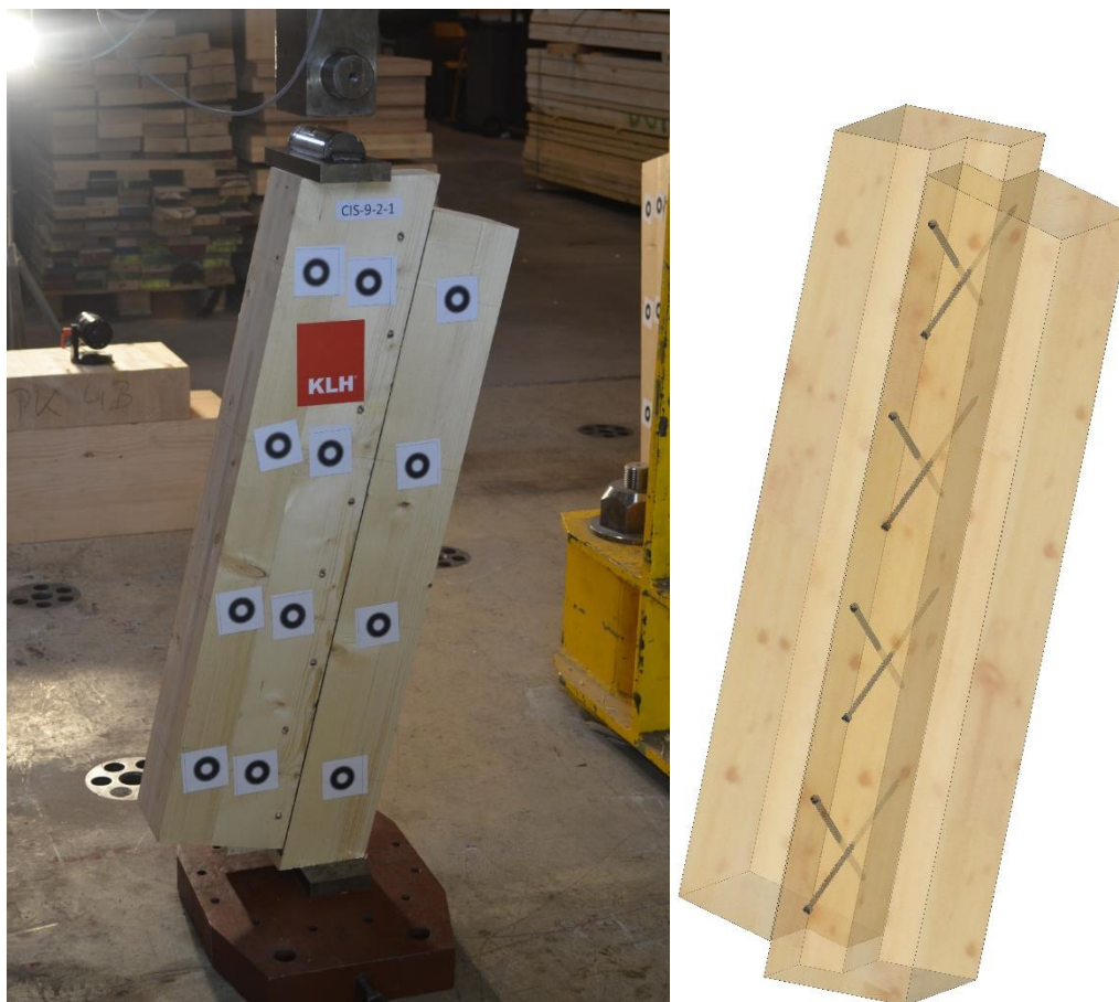
Figure 2-29 : Echantillon de la configuration CIS-9-2 (assemblage à mi-bois, vissage 45^\circ croisé)
