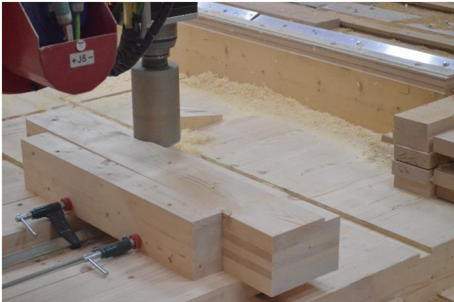
Figure 1-2 : Usinage des rainures avec le calibre.
