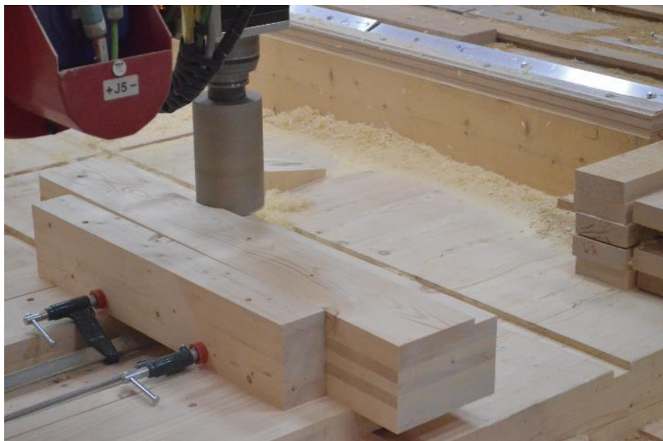
Figure 1-2 : Usinage des rainures avec le calibre.
