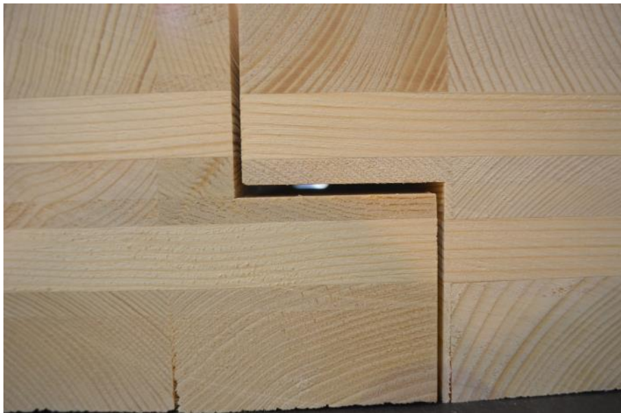
Figure 1-4 : Jeu d'assemblage pour les échantillons possédant un mi-bois.
