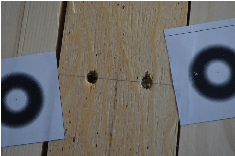
Figure 2-7 : Mode de rupture extérieur des assemblages de la configuration CIS-G-1 par l'arrachement du côté de la tête
