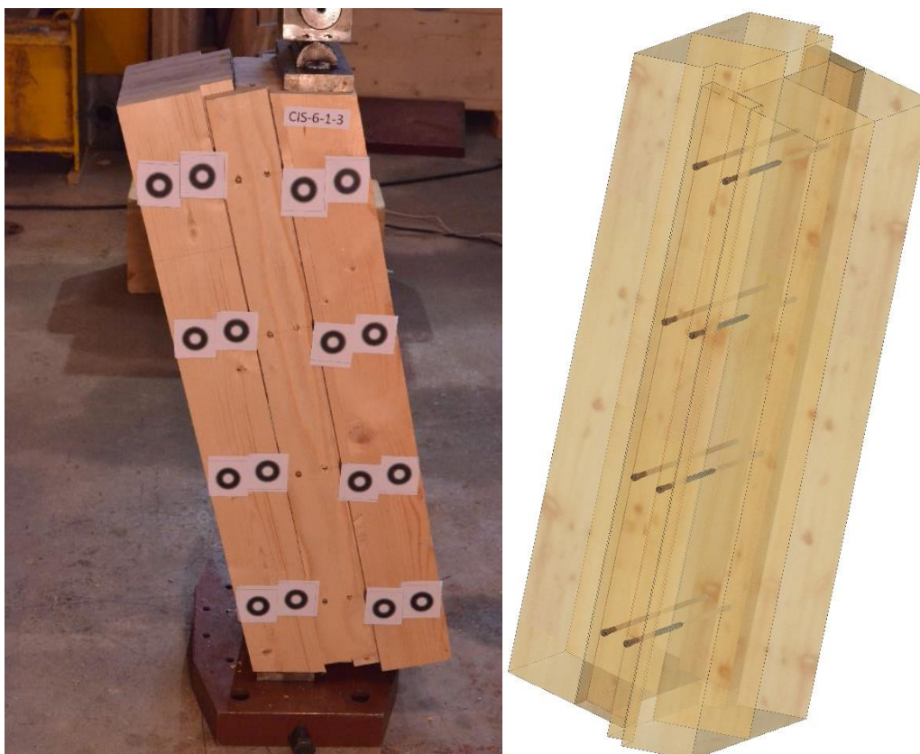
Figure 2-4 : Echantillon de la configuration CIS-6-1 (Rainure et languette LVL vissée à 90°)
