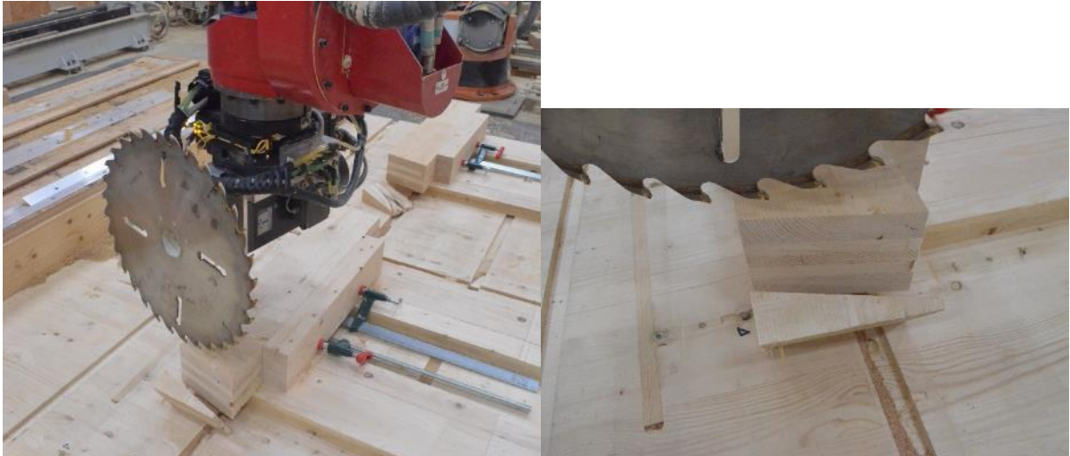
Figure 1-1 : Découpe à l'angle de la face d'appui.
