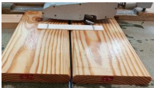
Figure 10 Maquette essais plan incliné pendule SRT lames en pin selon NF EN 16165 C
