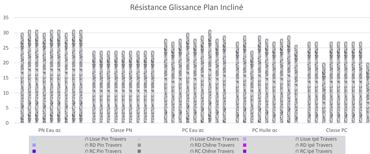
Figure 7 Résultats d'essais plan incliné sur lames Pin, lames Chêne lames Ipé en sens long.
