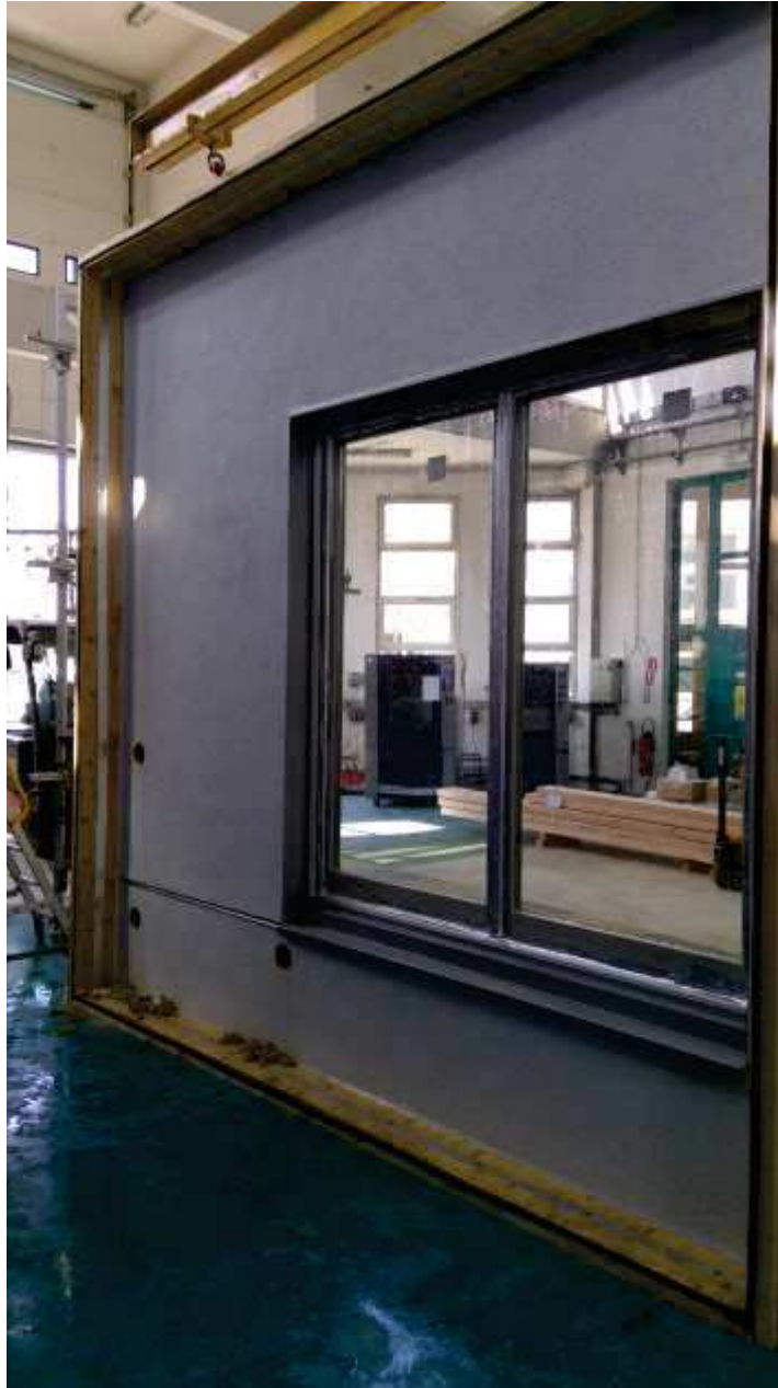
PHOTO N°2 – Objet A – Vue extérieure avec le procédé d'ETICS
