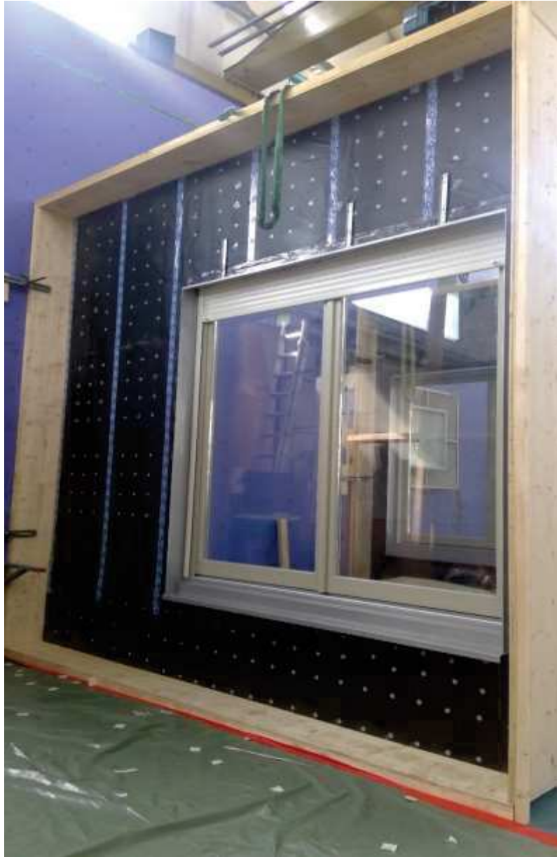
PHOTO N°1 – Objet A – Vue extérieure avec pare-pluie
