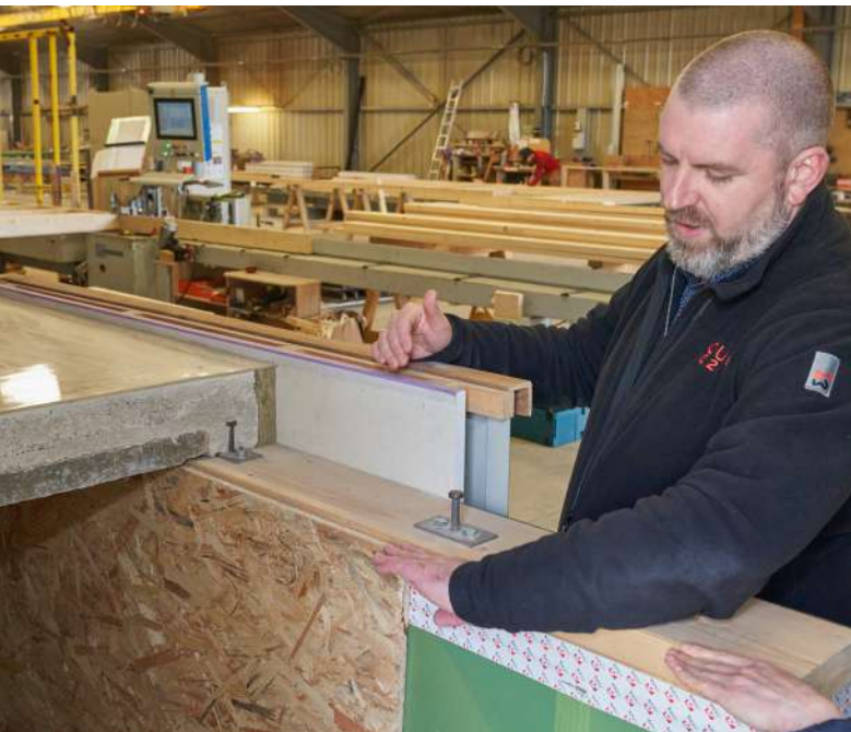
Guillaume Tondou, pilote opérations JO, présente le prototype de mur à ossature bois du lot PB10 avec plancher béton coulé en place, sous avis chantier
