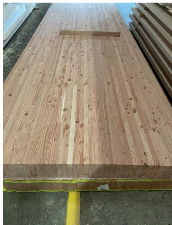
10 éléments préfabriqués au total qui constituent 6 tabliers qui seront assemblés sur place pour réaliser la passerelle.
