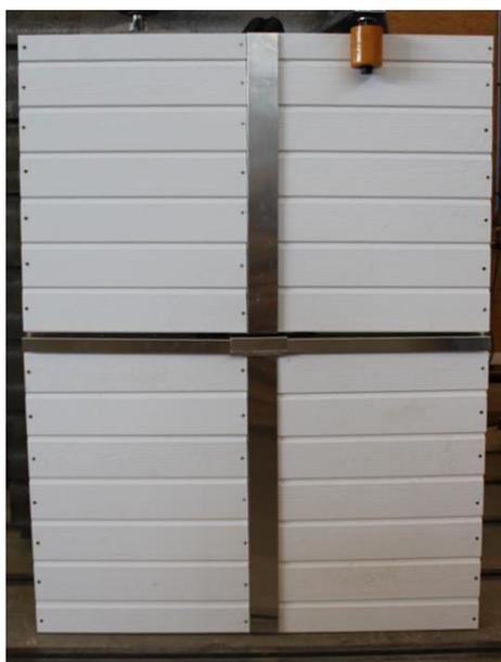
*Photo 7 : Maquette d'essai croix de jonction avec revêtement bardage bois*
