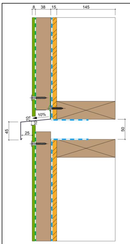
Figure 7 : Coupe verticale maquette croix de jonction – fibres-ciment
