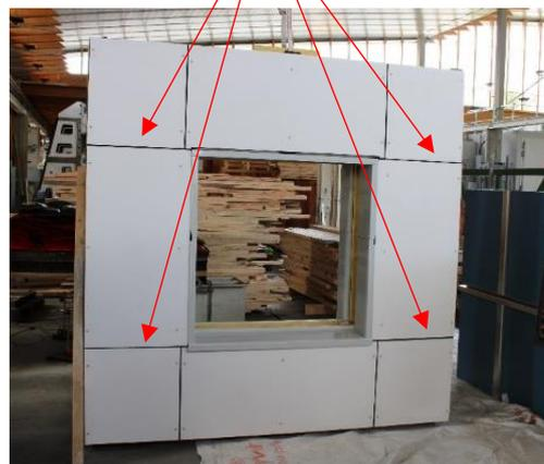
Photo 3 : Maquette FOB avec baie et revêtement extérieur en panneaux fibres de ciment
