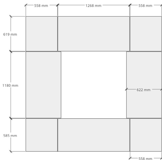
Figure 5 : Dimensions des Panneaux fibres-ciment
