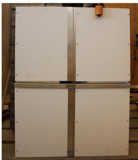
*Photo 6 : Maquette d'essai croix de jonction*
