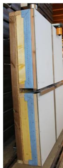
*Photo 7 : Maquette d'essai vue de côté avec revêtement en panneaux fibres-ciment*
