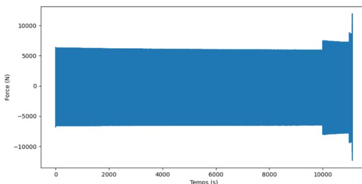
Figure 8 : Courbe de résultats d'essai de mise en parallélogramme Force / Temps
