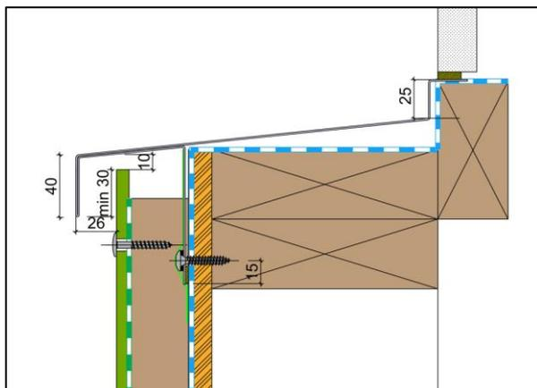
Figure 2 : chevêtre / appui – revêtement fibres-ciment
