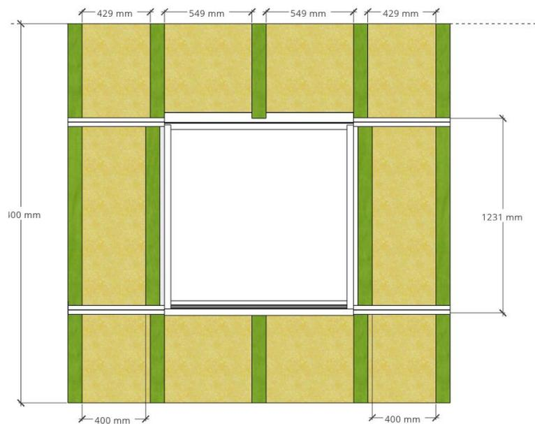
Figure 4 : Position et cotation des tasseaux supports de revêtement
