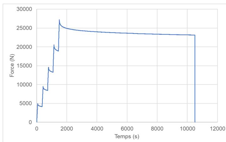
Figure 9 : Courbe d'essai de flexion 4 points Force / Temps
