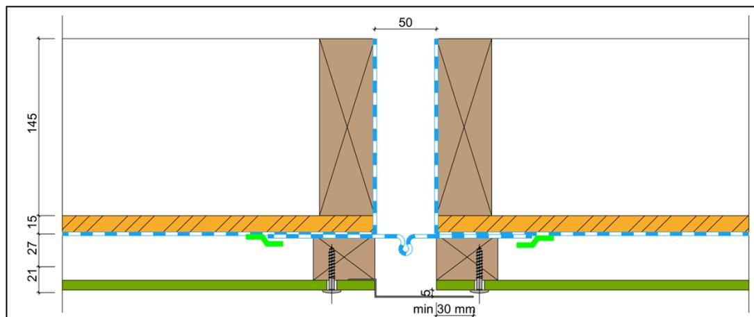
Figure 6 : Coupe horizontale maquette croix de jonction – fibres-ciment
