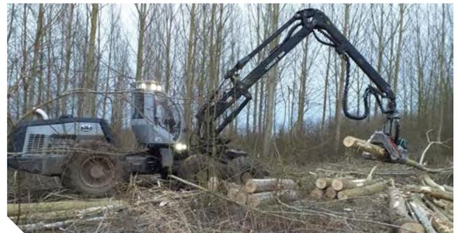
Porte-outil 6x6 de très grande capacité\* : puissance moteur de 300 ch, grue de 9,70 m de portée et couple de levage 290 kN.m. Machine adaptée à la récolte des gros peupliers
