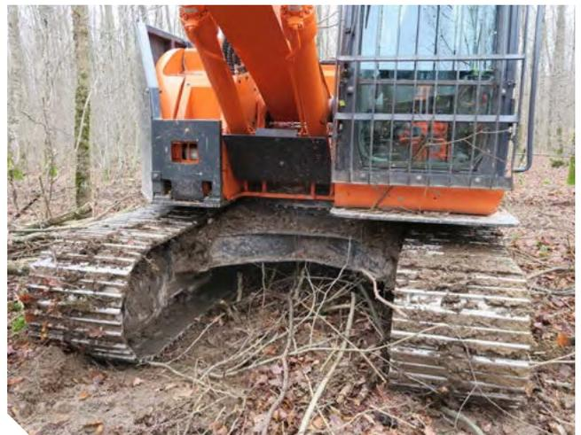
Pelle hydraulique de 14 tonnes équipée en chenilles métalliques de 600 mm de large
