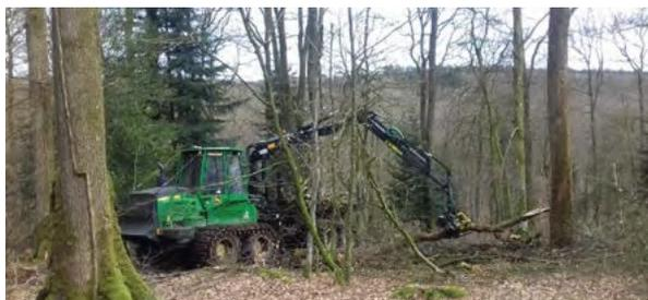
**Avantage:** système le plus performant économiquement car les produits sont chargés au fur et à mesure de leur façonnage. La portée de grue est généralement plus importante.
