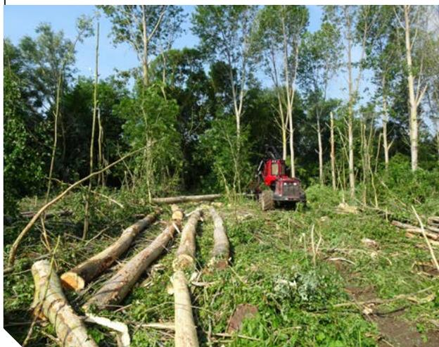
Grumes rangées sur la gauche, prêtes à être billonnées manuellement et cimes destinées au bois énergie posées sur la droite du cheminement de la machine
