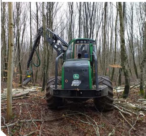
*Les porte-outils spécifiques de moyenne capacité (puissance moteur 160 à 210 ch) sont bien adaptés à ces premières éclaircies en vérifiant toutefois que la grue ait une bonne capacité (couple de levage 180 kN.m minimum) et une portée d'au moins 8,50 m, idéalement de 10 m.*
