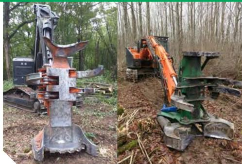
Têtes à disque et à sécateur/cisaille
