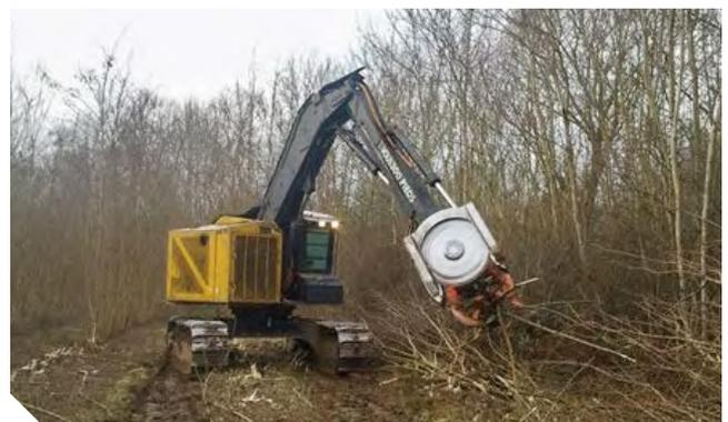
Tête à disque équipée de la fonction rotation facilitant la dépose du bois
