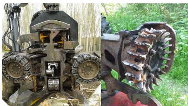
Exemple de rouleaux d'entraînement avec des petits picots sur barrettes flexibles sur caoutchouc pour la récolte de peupliers (à gauche) et de rouleaux avec une très bonne adhérence et une capacité autonettoyante appréciée en feuillu (à droite)
