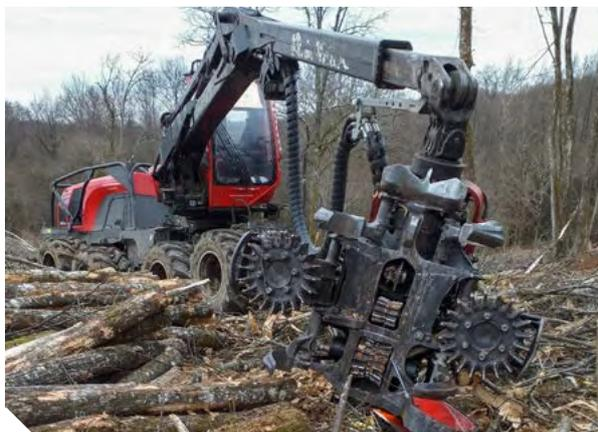
Exemple de tête à 4 rouleaux (capacité de coupe 65 cm) montée sur un porte-outil de 231 ch
