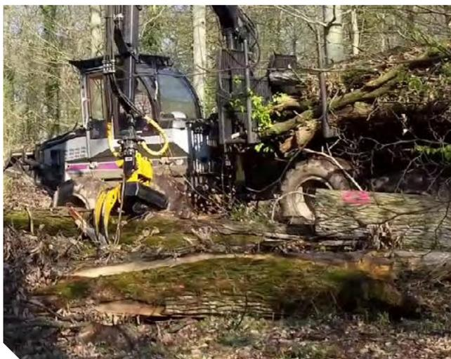
Une portée de grue de 10 m et un couple de levage important (> 120 kN.m) permettent de rester sur les cloisonnements. Un porteur 8 roues de 14 T de charge utile est idéal pour la stabilité de l'engin.
