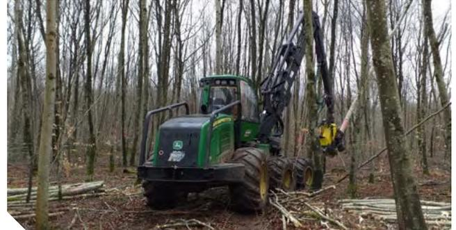
Porte-outil 6x6 de moyenne capacité\* : puissance moteur de 197 ch, grue de 9,70 m de portée, couple de levage 165 kN.m. Machine adaptée aux premières éclaircies feuillues
