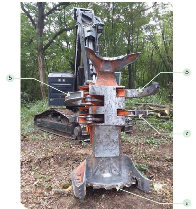
(a) disque, (b) 2 bras de préhension faisant fonction de grappin, (c) un bras accumulateur
