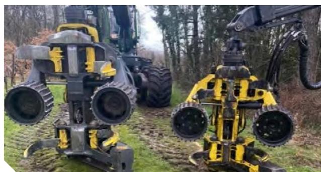
Exemple de têtes de bûcheronnage à 2 rouleaux d'entraînement à serrage parallèles : à droite une tête pour les premières éclaircies (diamètre d'abattage max. 520 mm), compacte (largeur bras ouverts 1 150 mm) et légère (moins de 800 kg). A gauche, une grosse tête (plus de 1 900 kg largeur bras ouvert 1 970 mm) adaptée aux bois moyens et gros bois (diamètre d'abattage max. 750 mm)
