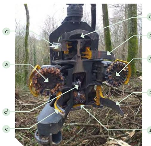
Un exemple de tête de bûcheronnage à 3 rouleaux d'entraînement (a), 2 couteaux fixes (b) et 4 couteaux mobiles (c). Roulette de mesure (d)
