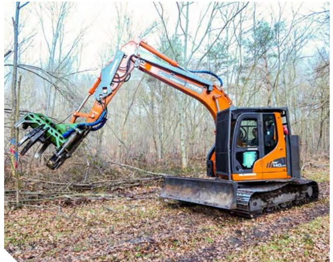
Pelle hydraulique de 14 tonnes à faible déport arrière, équipée de protections forestières au niveau de la tourelle et du bras et lame à l'avant.
