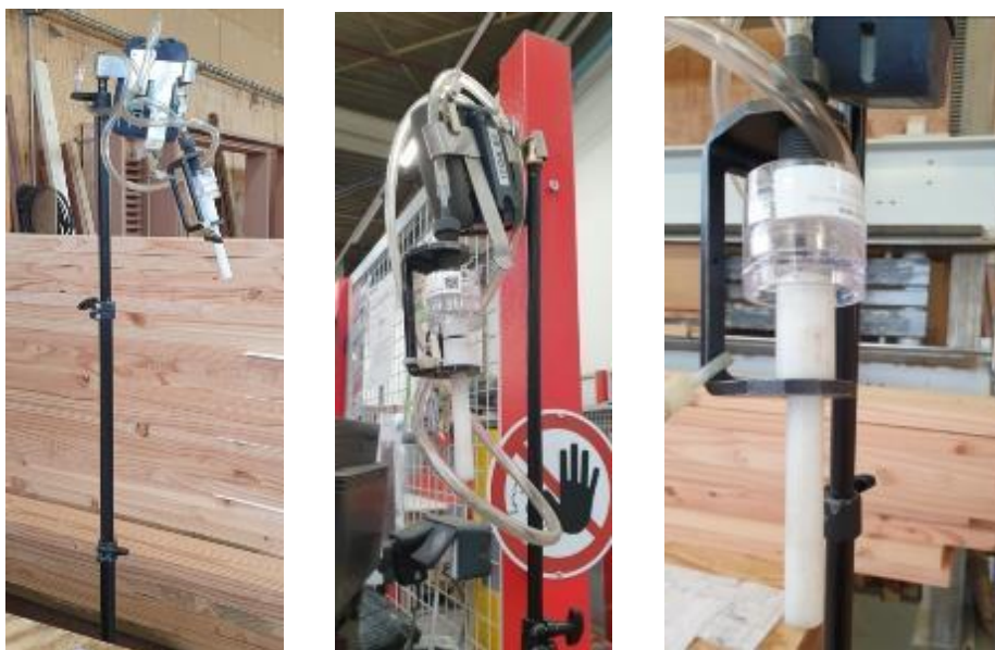
Figure 4 – Mise en œuvre du dispositif de prélèvement de poussières alvéolaires sur trépied
