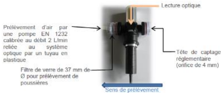
Figure 6 – Dispositif de mesure optique CASELLA CEL avec adaptateur gravimétrique
