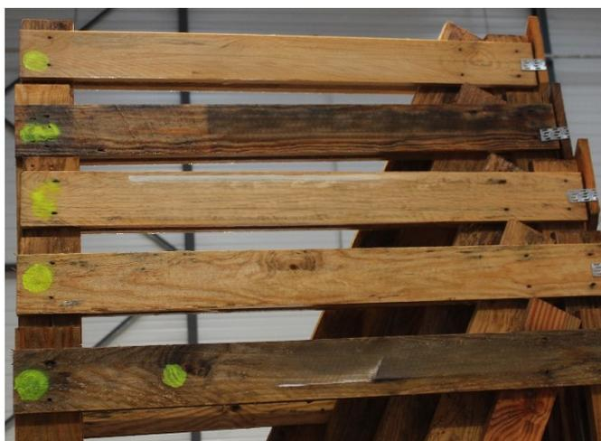
Figure 14 : Exemple de marquage d'un passage en atelier de reconditionnement à la peinture
