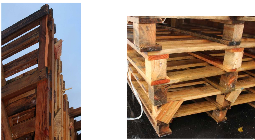
Figure 4 : Exemples de défauts relevés au niveau des jambes de force de palettes à dossier
