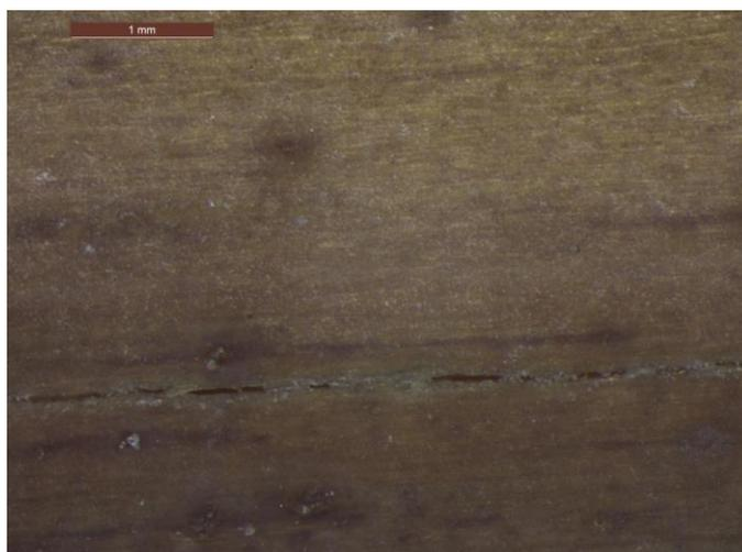
Figure 8 : Système 9 - craquelage observé à la loupe binoculaire (X25)
