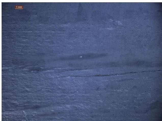
Figure 7 : Système 1 - craquelage observé à la loupe binoculaire (X6,3)
