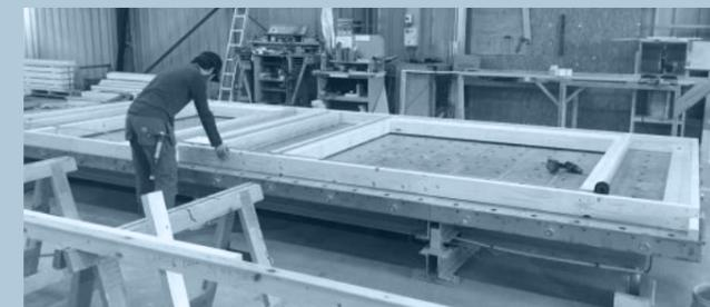
ASSEMBLAGE D'UN MUR OSSATURE BOIS EN ATELIER
