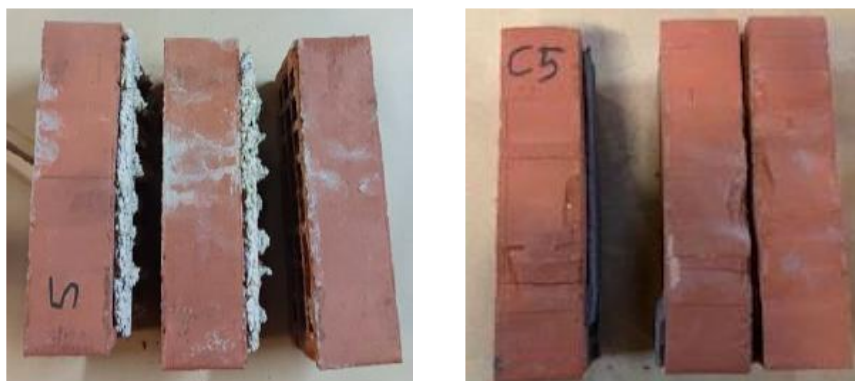
Figure 5 : Essais de cisaillement de briques perforées (gauche) et pleines (droite)
