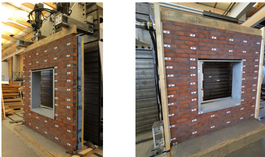
Figure 4 : Maquette des essais de déformations différentielles à gauche et de mise en parallélogramme cyclique à droite
