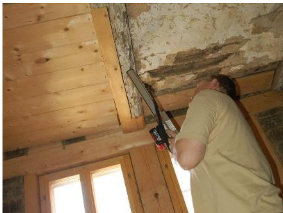
Photo 15 Sondage au résistographe (Source : IML®)
