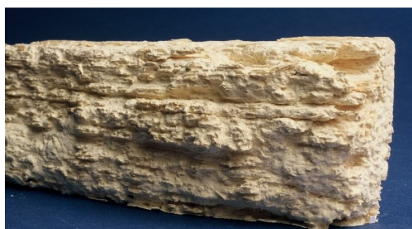
Photo 9 Dégâts de lyctus
