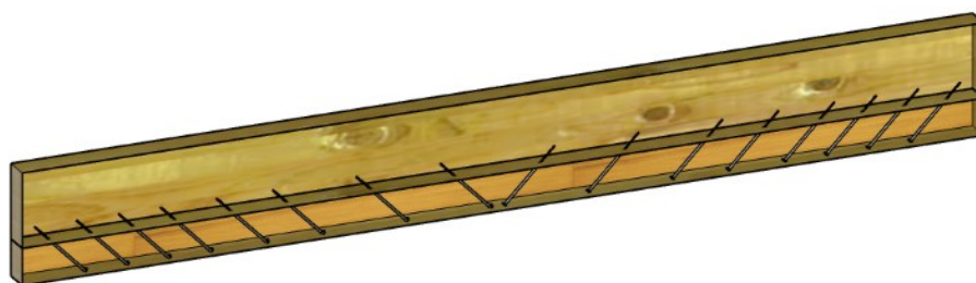
Figure 51 Renfort bois en face inférieure assemblé par vis inclinées
