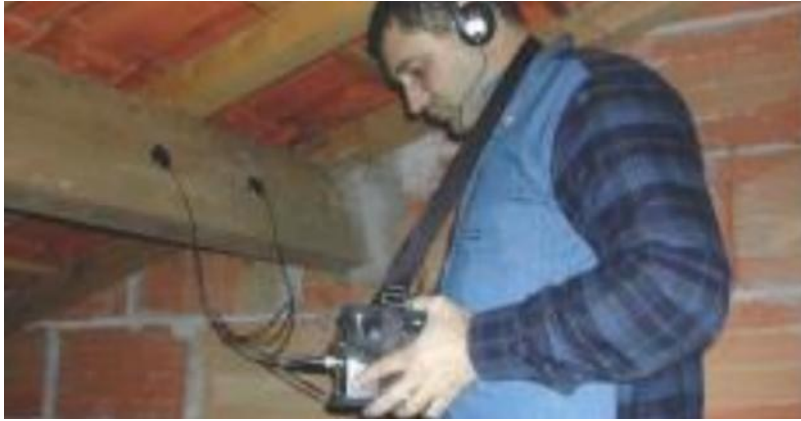
Photo 16 Détection acoustique (source INADEC ® INsect Acoustic DEteCtion)
